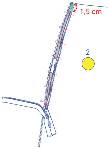
Pliez le ruban de la fermeture avec l'étoile verte vers la droite et épinglez-le sur le DSD, endroit contre endroit. Le côté du ruban correspond au bord surjeté du tissu. Les dents de la fermeture éclair sont posées à 1,5 cm sous le bord non fini de l'encolure. Piquez à l'aide du pied-de-biche pour fermeture éclair invisible.
