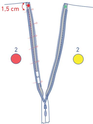
Pliez maintenant le ruban de la fermeture avec l'étoile rouge vers la gauche et épinglez-le sur le DSG, endroit contre endroit. Le côté du ruban correspond au bord surjeté du tissu. Les dents de la fermeture éclair sont posées à 1,5 cm sous le bord non fini de l'encolure. Piquez à l'aide du pied-de-biche pour fermeture éclair invisible.
