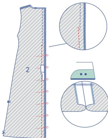
Fermez la fermeture éclair et épinglez le restant de la couture MDS sous la fermeture éclair. Piquez avec le demi-pied-de-biche ou le pied-de-biche pour fermeture éclair. Commencez à piquer un peu au-dessus et sous la piqûre précédente (pour piquer les rubans de la fermeture éclair). Ouvrez la valeur de couture.
