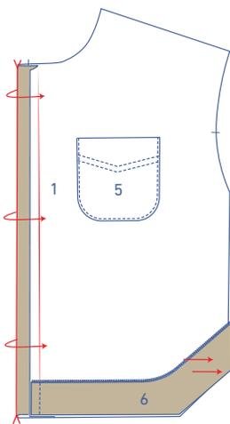
Pliez la parmenture du DV avec la parmenture, sur la ligne de pli repassée au niveau des crans en v pour faire concorder exactement les lignes d'ourlet, endroit contre endroit.
