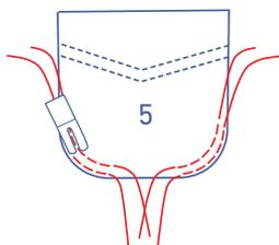
Réalisez 2 piqûres parallèles sur les arrondis de la poche avec un grand point et une tension basse. Laissez une petite longueur de fil aux deux extrémités.
