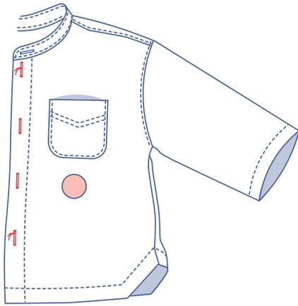
Réalisez des boutonnières verticales sur le DVG. La position du premier et du dernier bouton est indiquée sur le patron. Répartissez la distance harmonieusement pour déterminer les positions des autres boutons.
