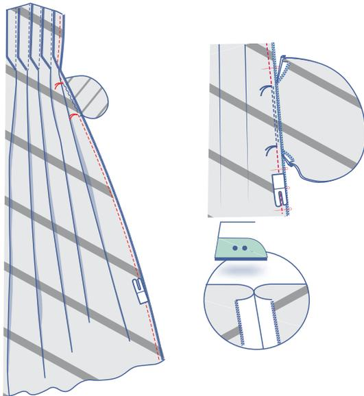
Die rechte Seitennaht stecken und genau bis zum Heftfaden, der den oberen Rand der Taschenöffnung markiert, nähen. Dann weiter vom nächsten Heftfaden bis zum Saum nähen. Die Nahtzugabe der Taschenteile zur Seite schlagen, um gut bis zu den Heftfäden nähen zu können. Die Nahtzugabe auseinander bügeln.
