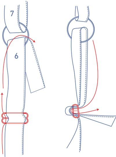
Durch den Ring ziehen und danach wieder nach unten falten, um ihn von hinten durch den Schieberegler zu ziehen.
